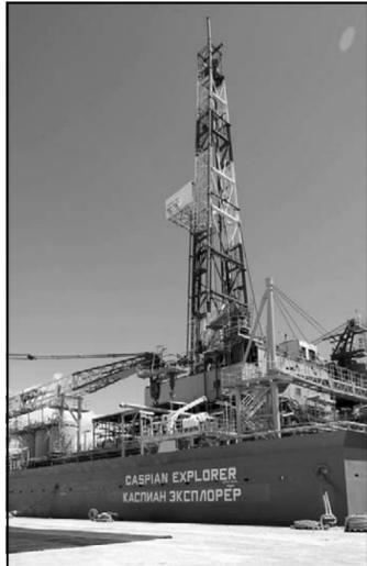
их сборка осуществлялась на производственных мощностях, в судовой верфи казахстанской компании ТОО «Ерсай Каспиан Контракторс», Мангистауская область. Данная установка предназначена для работ на мелководье – 2,5-5,5 метров, с максимальной глубиной бурения скважин до 6 тыс. метров.
