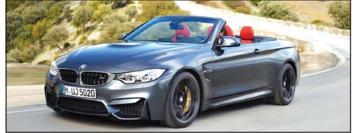
шей, которая способна складываться за 20 секунд на скорости до 18 км/ч. Под капотом нового M4 скрывается 3,0-литровый силовой агрегат мощностью 425 л.с. С ним кабриолет M4 разгоняется от 0 до 100 км/ч за 4,2 секунды, когда автомобиль оснащается 7-скоростной трансмиссией с двойным сцеплением. Максимальная скорость авто – 250 км/ч.
